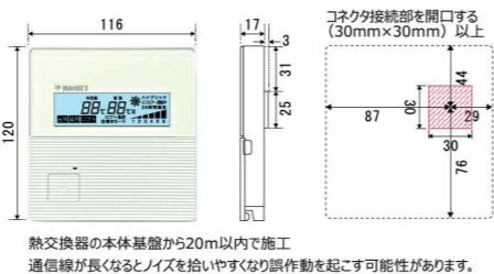
熱交換器の本体基盤から20m以内で施工
