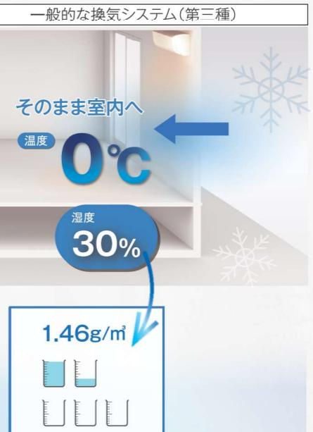
一般的な換気システムの場合は、換気時に暖気をそのまま捨て、外気をそのまま取り入れるため、室内に供給される空気にはコップ約1.5杯分の水蒸気しか含まれていません。
