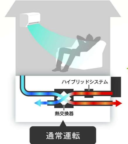
熱交換器を通して外気を床下へ取り込みます。
