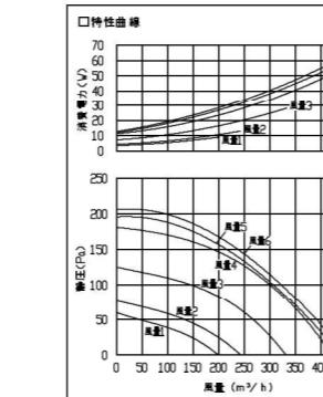
熱交換器消費電力=給気ファン消費電力+排気ファン消費電力+基板消費電力(2W)
