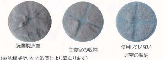
〈約1ヶ月経過した排気フィルター〉 旧タイプの室内排気口使用時
